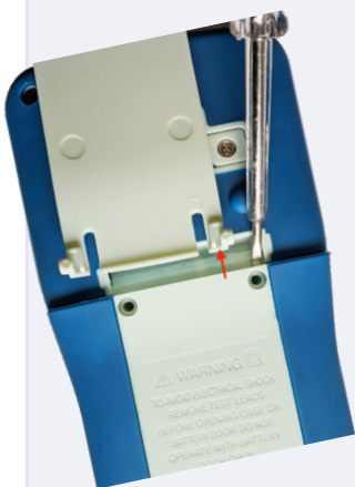
Bild 7. Da der Deckel nicht freiwillig abging, brauchte ich Hebelgewalt.
