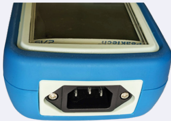
Bild 4. Oben auf der Stirnseite befindet sich eine Kaltgerätebuchse zum Anschluss von Messkabeln.
