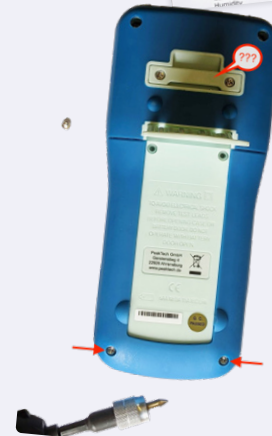
Bild 6. Beim Batteriefach empfehlen sich mittlere Kreuzschlitz-Bits. Oben bei ??? kann eine Schlaufe befestigt werden. Hätten Sie es gerne am Gürtel, wenn 230 V anliegen?
